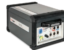
TDX120 Modul IT pentru test capacitate și factor de putere
