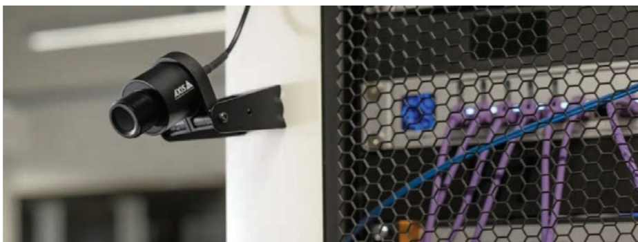
Senzorul termic compact AXIS F2180-TE permite monitorizarea precisă a temperaturii chiar și în spații limitate. Ajută la detectarea timpurie a supraîncălzirii echipamentelor și la prevenirea opririlor costisitoare ale operațiunilor.
