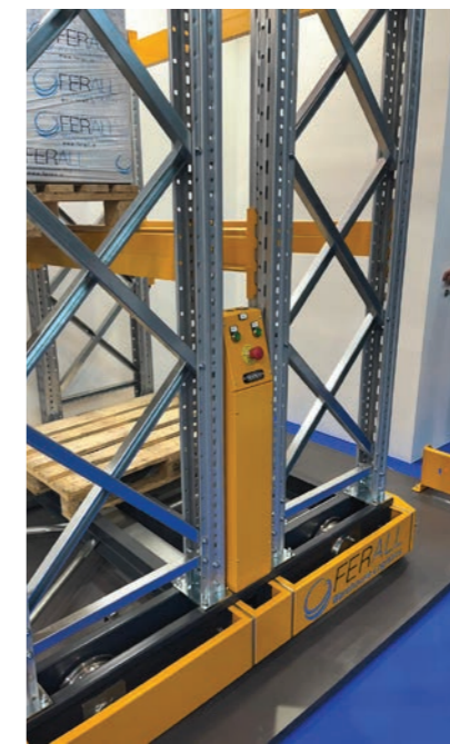
Baza închisă a șasiului de la raft simplifică considerabil cablarea.
