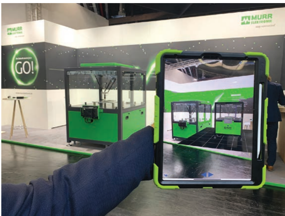
Instalația automatizată cu Vario-X are încă de la început un gemăn digital: o copie mobilă 1:1 a instalației reale, care include toate funcțiile și toți parametrii sistemului ulterior.
