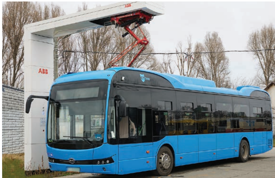
Încărcare la depou cu sistem Pantograf Coborâtor
