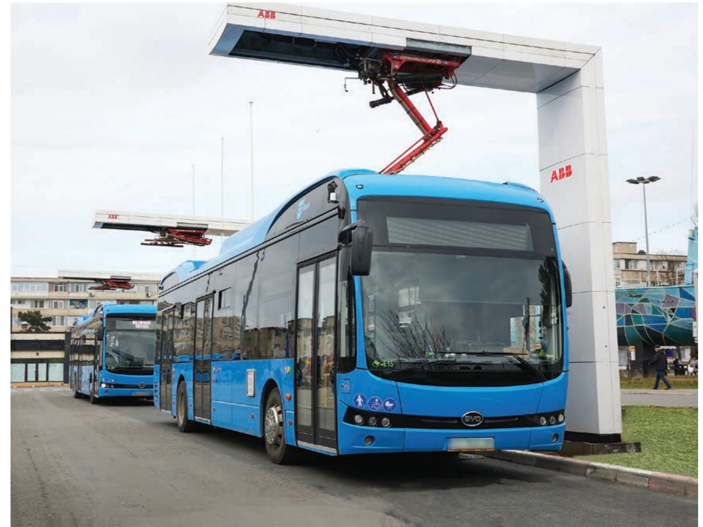
Încărcare pe traseu cu sistem Pantograf Coborâtor
