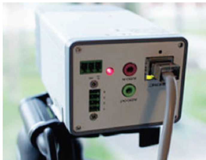
Cameră IP alimentată de la Power over Ethernet
