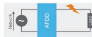
Arc serie – afectează două părți ale aceluiași conductor I_{arc} < I_n
